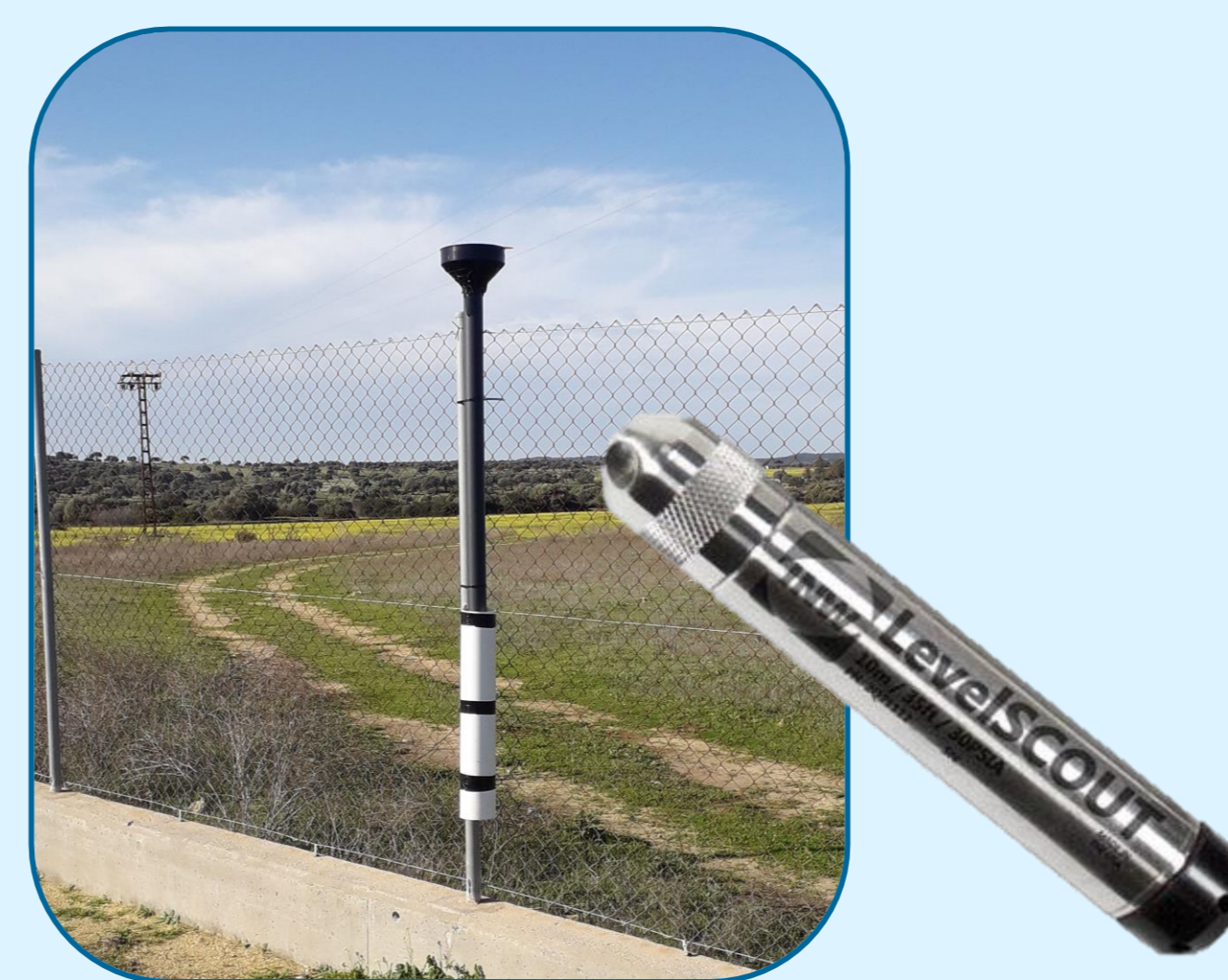
Figura 2. Pluviocaptador n.º 6 y datalogger Levelscout 10m PSIA
